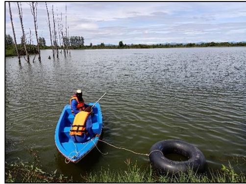
รูปที่ 2-20 ตรวจวัดระดับความลึกบ่อ
